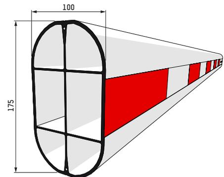
\* Peso de la viga por metro lineal = 6,2 kg/m.
