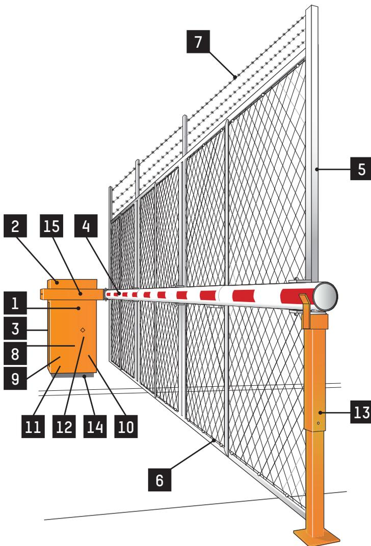
La barrera levadiza electromecánica con valla rígida de tipo **BLG 76** controla el acceso de vehículos a una zona controlada. La valla rígida impide el acceso de peatones, salvo los debidamente autorizados.
